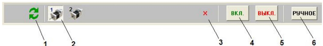
Рис. 25 Расположение кнопок на контрольной панели.
