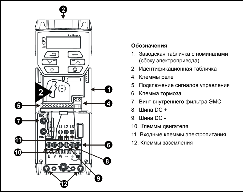
Рис. 3-1 Расположение деталей (показан габарит 2)
