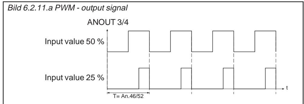
6.2.12 Analog Output / Functions (An.31/An.36/An.41)
